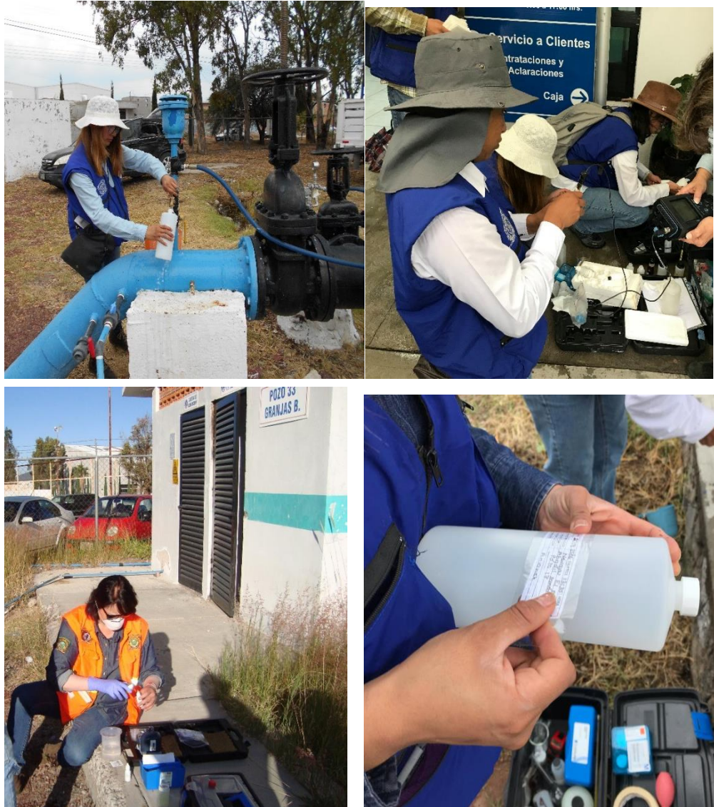
Figura 4.3. Toma de muestras y mediciones de parámetros inestables en campo. Acuífero Valle de San Juan del Río.
